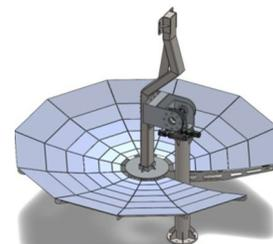
El Concentrador de Energía Solar basado en Stirling, CES-Stirling, concentra la energía proveniente del sol a través de un paraboloide circular, que proyecta los rayos solares hacia un punto único denominado foco de la parábola, punto en el que se ubica una cámara térmica que entrega la energía calórica al motor Stirling, que mueve un alternador para la generación de energía eléctrica de 220/110 VAC.
